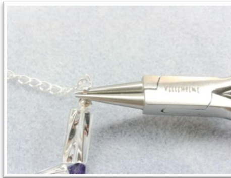
20. Pujota säätöketjun pää solmusuojan lenkkiin ja käännä lenkki silmukalle pyöröpihdeillä.
