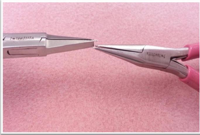
15. Avaa välirengas tasapääpihtien ja puolipyöröpihtien välissä sivusuunnassa.
